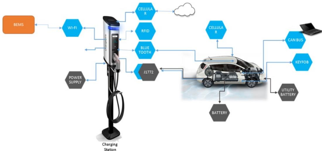
Figura 9- L'interazione cyber-fisica tra L'EVSE e il PEV
